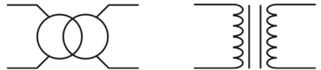
Un transformateur est constitué d'un circuit magnétique sur lequel sont disposés deux bobinages en cuivre : le primaire et le secondaire.
