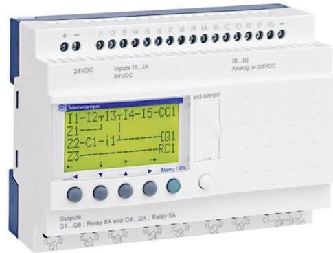
Le type monobloc possède généralement un nombre d'entrées et de sorties limités. Bien qu'il soit parfois possible d'ajouter des extensions d'entrées/sorties, le type monobloc a pour fonction de résoudre des automatismes simples faisant appel à une logique séquentielle et utilisant des informations tout-ou-rien.
