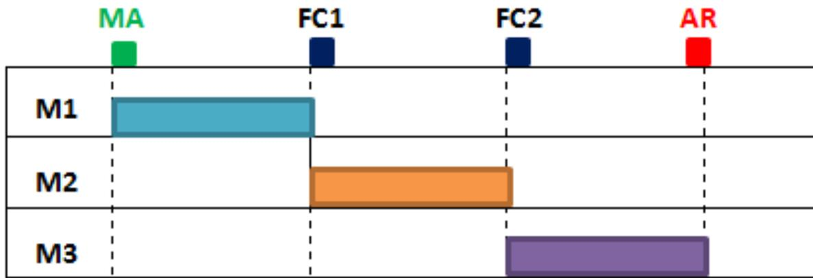
M1, M2, M3 : moteurs asynchrones triphasé avec démarrage direct
