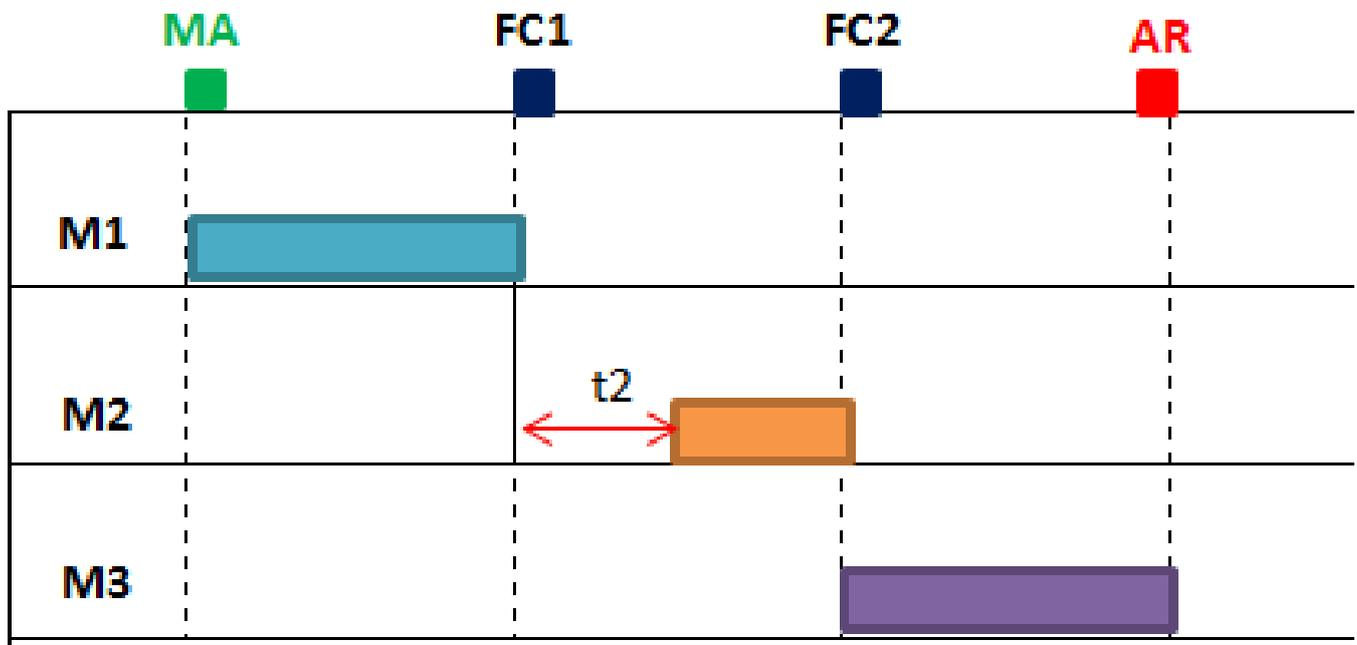
**M1, M2, M3 : moteurs asynchrones triphasé avec démarrage direct**
