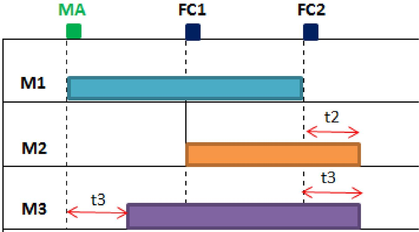
*M1, M2, M3 : moteurs asynchrones triphasé avec démarrage direct*
